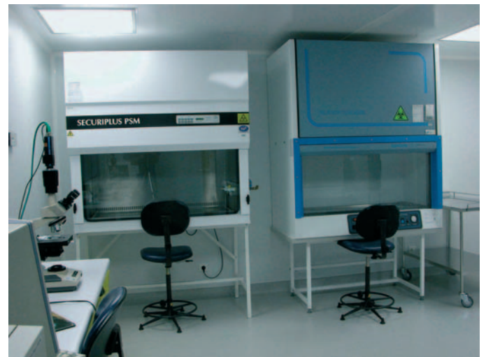
Figure 1. Salle blanche (zone d'atmosphère contrôlée) de préparation des tissus. L'accès se fait par un sas.
